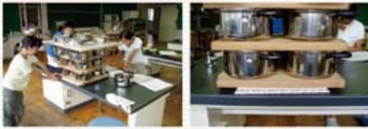
限界圧力測定中：左端人物が指差している白色のものが、サンドイッチ板構造造りの床版橋。サンドイッチ板構造の限界圧力は、折板に曲がりが発見されたときの圧力とする。
